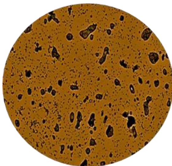
Рисунок 3.1 – Микроструктура штамповой стали X12Ф1
